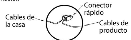
**NOTA:** Información importante alambre. Valor máximo de la temperatura de 105° C (221° F). 600 voltios máximo para la construcción de alambre y 1000 voltios máximo en los signos y artefactos de iluminación. El rango de cable aceptable incluye: Sólido: 12-18 AWG.
