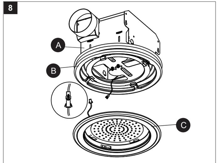
9. Placer l'ensemble de lumière / jante (C) jusqu'à l'ensemble de lumière / jante (B) et alignez les quatre boucles de verrouillage de bord. Ensemble de lumière / jante (C) dans l'ensemble de lumière / jante (B) et de faire tourner le sens antihoraire jusqu'à ce que l'ensemble de lumière / jante (C) s'arrête pour se verrouiller en place.
