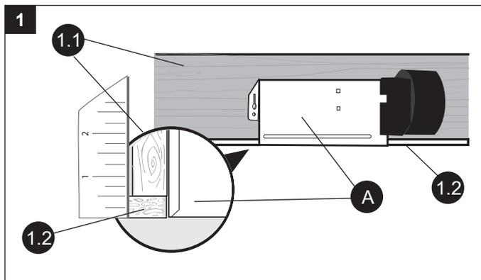
2. Instale la carcasa del ventilador (A) en la vigueta usando los tornillos para madera largos (AA) en ambos lados.
