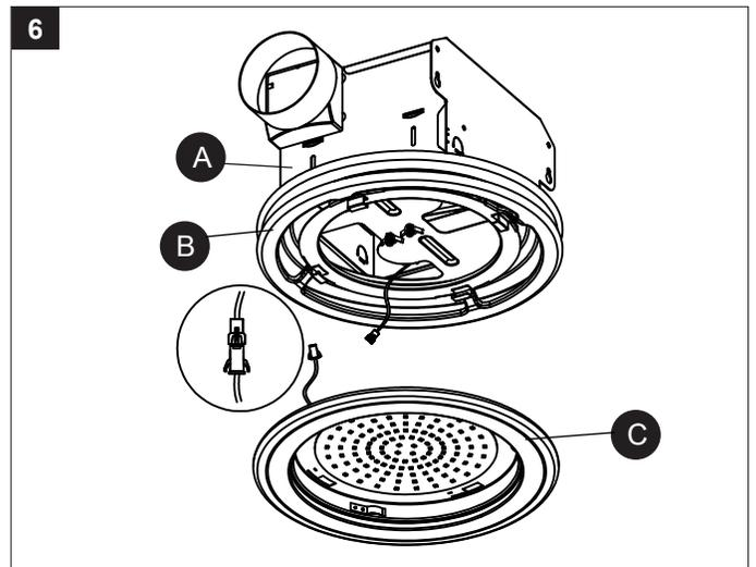
7. Coloque el ensamble de lámpara/reborde (C) hasta el conjunto de luz/borde (B) y alinee las cuatro hebillas de bloqueo de la llanta. El ensamble de lámpara/reborde (C) en el conjunto de luz/borde (B) y gire en sentido antihorario hasta que el conjunto de luz/borde (C) se detenga para bloquear en su lugar.
