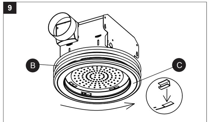
10. Placez le globe en plastique (C) jusqu'à la lumière/jante/ assemblage (B). Alignez les trois clips de verrouillage de la jante sur l'ensemble lumière/jante (B) avec les encoches sur le globe en plastique (C). Enfoncez le globe en plastique (C) dans l'ensemble lumière/jante (B) et tournez dans le sens des aiguilles d'une montre jusqu'à ce que le globe de verre s'arrête (ouverture à distance de 5-3/16") pour le verrouiller.
