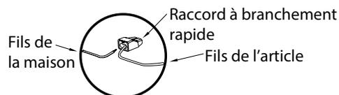
**REMARQUE :** Information importante pour le raccordement. La cote de température maximale est de 105 °C (221 °F). Maximum de 600 V pour les fils de bâtiment; maximum de 1000 V, pour les fils de bâtiment; maximum de 1000 V, pour les panneaux et les luminaires. Le calibre des fils acceptable est : de 12 à 18 AWG pour le fil massif.
