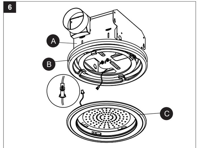
9. Coloque el ensamble de lámpara/reborde (C) hasta el conjunto de luz/borde (B) y alinee las cuatro hebillas de bloqueo de la llanta. El ensamble de lámpara/reborde (C) en el conjunto de luz/borde (B) y gire en sentido antihorario hasta que el conjunto de luz/borde (C) se detenga para bloquear en su lugar.
