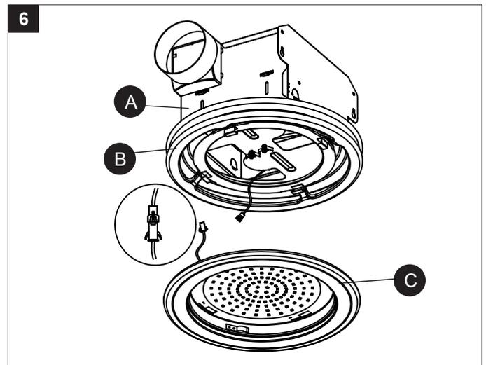
7. Placer l'ensemble de lumière / jante (C) jusqu'à l'ensemble de lumière / jante (B) et alignez les quatre boucles de verrouillage de bord. Ensemble de lumière / jante (C) dans l'ensemble de lumière / jante (B) et de faire tourner le sens antihoraire jusqu'à ce que l'ensemble de lumière / jante (C) s'arrête pour se verrouiller en place.
